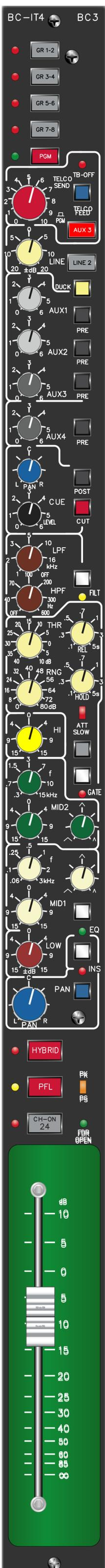
Das Eingangsmodul BC-IT4 ist im Vergleich zum IT3 mit einigen zusätzlichen Bearbeitungsmitteln ausgestattet. IT4 ist das AT-Monomodul des BC3-Systems für Telefonanbindung und Konferenzschaltungen. Zwei umschaltbare Eingänge, eine komfortable Rückspieleinrichtung sowie ein 4-Band-EQ mit 2 Sweep-Bändern und eine regelbare Höhen- und Tiefensperre gehören zur Grundausstattung dieses Moduls.
